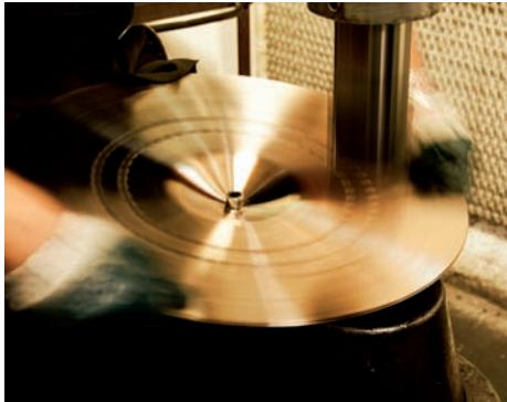
presenti sul mercato sono il risultato di un procedimento di laminazione e successivo stampaggio della campana, gli UFIP appartenenti alle linee professionali in B20, sono ottenuti tramite un processo di fusione a centrifuga che assicura l'eliminazione delle impurità presenti nella lega di bronzo, garantendo nel contempo uno spessore della campana maggiore rispetto ai piatti ottenuti per semplice stampaggio.
